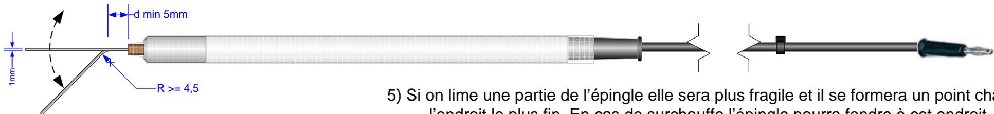
5) Si on lime une partie de l'épingle elle sera plus fragile et il se formera un point chaud à l'endroit le plus fin. En cas de surchauffe l'épingle pourra fondre à cet endroit.
